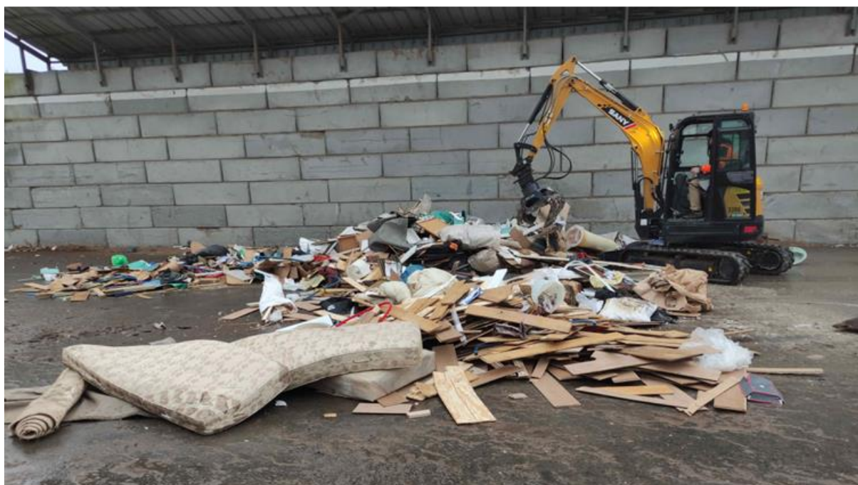
Figure 1 : Tri mécanisé de la fraction > 400 mm (Crédits TERRA)
